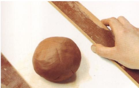
1- Para obtener la base, con arcilla se forma una bola y se coloca sobre la superficie de trabajo, flanqueada por sendos listones que servirán de guía para el rodillo y de medida y para el grosor de la base.
