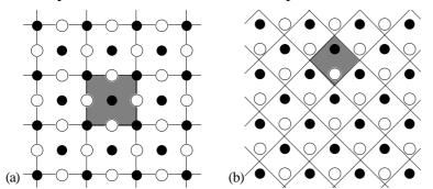
Figura 4.2. Un sólido de dos dimensiones y dos opciones de celdilla unidad. Cualquiera de las dos reproduce el cristal completo, pero se prefiere generalmente la opción (a) ya que muestra la máxima simetría de la estrutura, contrariamente a (b).
