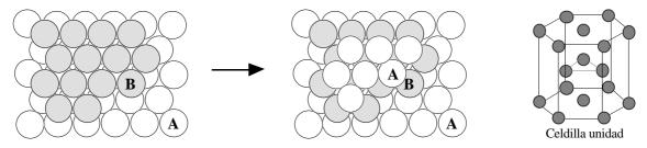
Empaquetamiento cúbico compacto. La tercera capa (C) se dispone sobre los huecos de la segunda que coinciden con huecos de la primera. La cuarta capa coincide con la primera. La disposición es ABC-ABC... y la celdilla unidad es cúbica centrada en las caras. Ejemplos son el aluminio, cobre, plata y oro.
