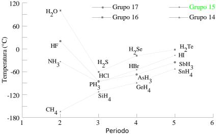
Figura 4.1. Temperaturas de ebullición de algunos compuestos simples de hidrógeno. Las líneas conectan moléculas que contienen átomos del mismo periodo. Obsérvese el efecto del enlace de hidrógeno en los puntos de ebullición del agua, fluoruro de hidrógeno y amoníaco.
