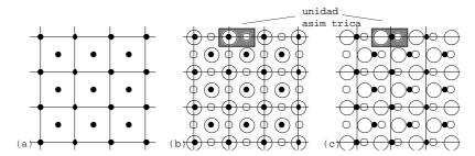
Figura 4.3. (a) Representación de los puntos de la red del NaCl, cuya estructura se muestra en (b) o (c). Cada punto representa la localización de una unidad asimétrica Na<sup>+</sup>Cl<sup>-</sup>. La situación del punto en la unidad asimétrica es arbitrario. En (b) se ha puesto en el ion Cl<sup>-</sup>; en (c) en un punto intermedio entre los iones Na<sup>+</sup> y Cl<sup>-</sup>, con igual resultado.
