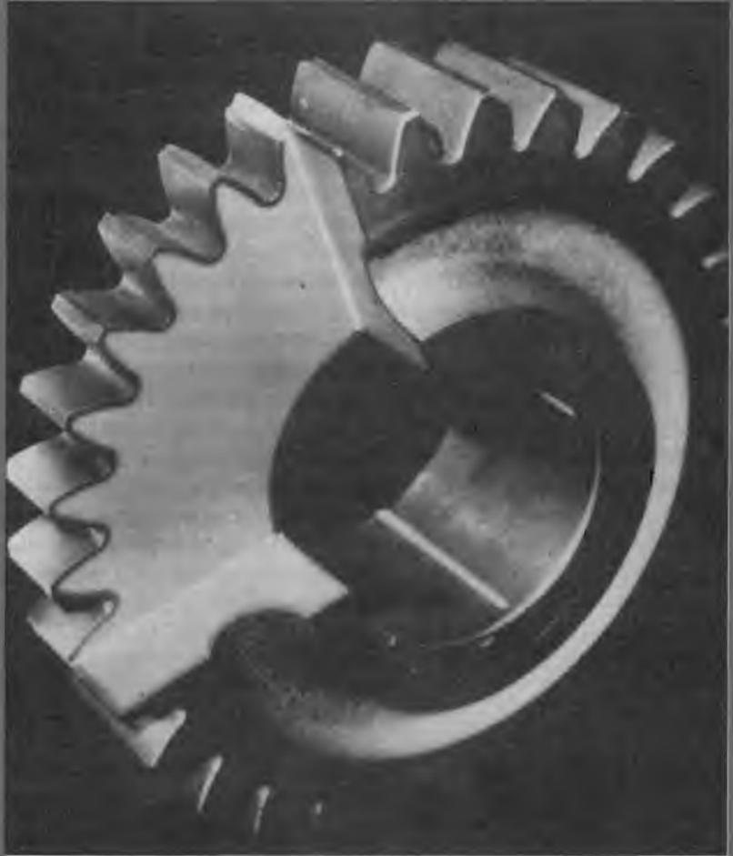
Fotografía de un engranaje de acero que ha sido endurecido superficialmente. La capa exterior de la superficie se ha endurecido selectivamente por un tratamiento térmico de difusión del carbono de la atmósfera a elevada temperatura. La zona endurecida aparece como el margen exterior oscuro del segmento del engranaje seccionado. Tamaño real. (Fotografía cortesía de Surface Division Midland-Ross.)
