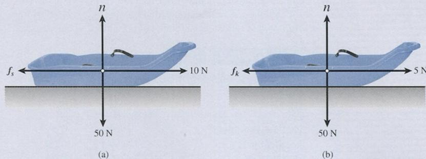
**Figura 4.14** (a) Se precisa una fuerza de 10 N para contrarrestar la máxima fuerza de fricción estática. (b) Se necesita una fuerza de sólo 5 N para mover el trineo con rapidez constante. (Fotografía de Hemera Inc.)
