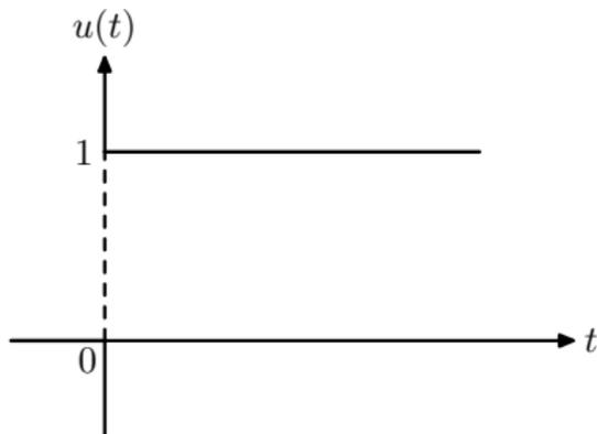
Como podemos ver, esta función cambia bruscamente desde cero hasta el valor unitario para el tiempo  $t = 0$ . En ingeniería esta notación es conveniente para representar el cierre de un interruptor para  $t = 0$ . Para el caso en que  $V_0 = 1$  el producto  $V_0 u(t) = u(t)$ , y su transformada de Laplace es
